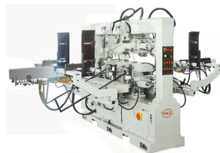
Máy làm mộng âm hình tròn & oval, đa mũi, Có hệ thống nạp liệu tự động, tốc độ 2400 mộng/giờ
