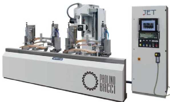
Máy JET CNC (Paolino Bacci) Chuyên phay, khoan, bào, làm mộng 5 chiều
